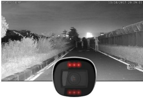
Bei schlechten Lichtbedingungen, zum Beispiel nachts, schaltet die Kamera automatisch in den Schwarz/Weiß-Betrieb um. Die Sicht wird zusätzlich durch die integrierte Infrarotbeleuchtung unterstützt. Die Kamera besitzt einen eingebauten Infrarot-Sperrfilter (IR-Cut-Filter). Damit werden störende Einflüsse der IR-Strahlung auf die Abbildungsqualität des Sensors vermieden.
